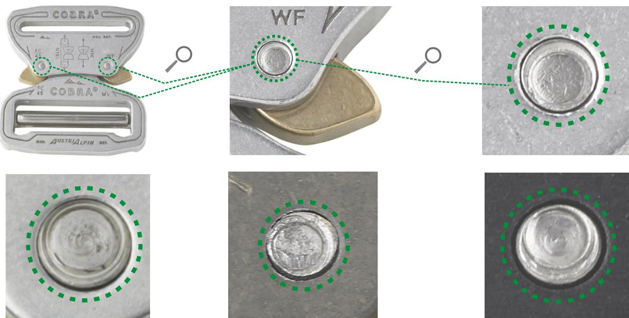
Der Niet weist sowohl auf der Vorder- als auch auf der Rückseite eine Prägung in Form eines Rings auf.
